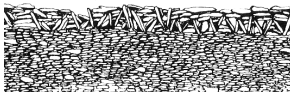
1) Caselle e muretti a secco 2) in agro di Canosa lungo il versante nord realizzato con blocchi di affiormanto in calcarenite e arenarie argillose
